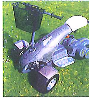
Véhicule tricycle électrique SCUBE avec une carrosserie en 100% lin.
